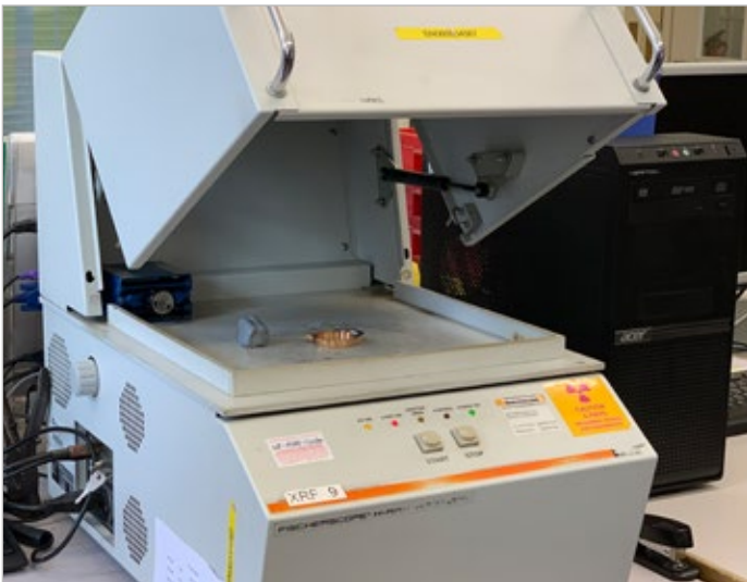
Prüfung des Goldgehalts
