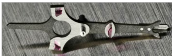
Anker der Doppelimpulshemmung
